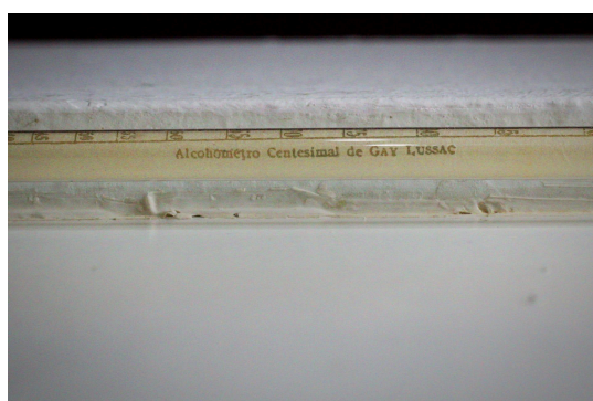
Figura 67: L'alcohòmetre en detall, on s'aprecia l'escrit "Alcohòmetre centesimal de Gay-Lussac".
