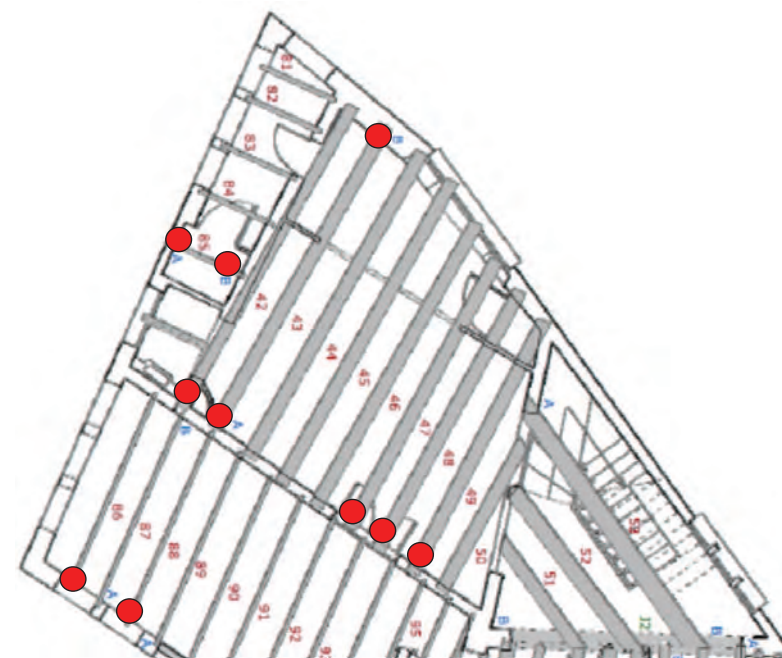
Identificació i situació parcial de punts singulars en l'entramat de bigues en Planta Primera
