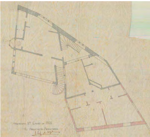
Esquema en planta dels cossos afegits per Puig i Cadafalch, diferenciant el que es creu que són dues campanyes constructives
