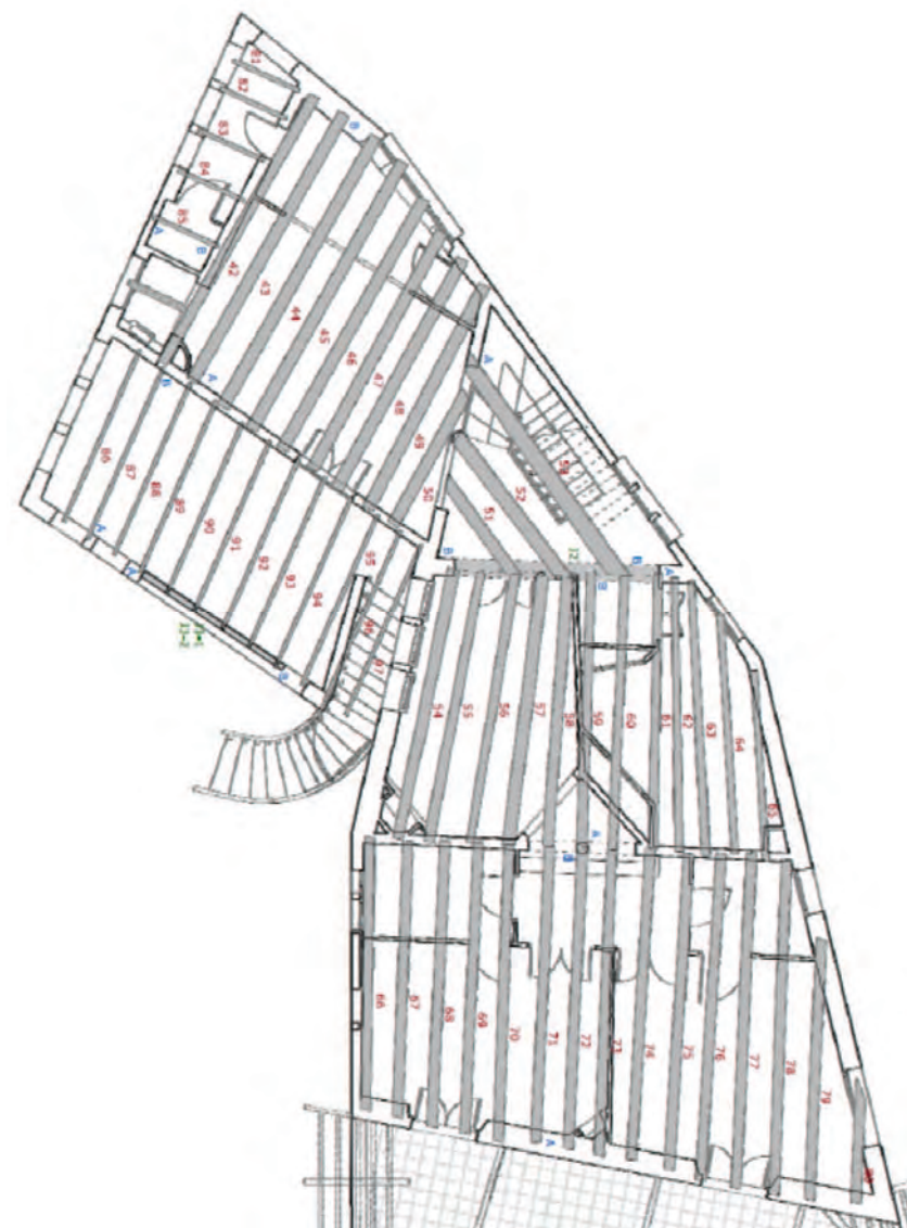
Identificació i situació general de l'entramat de bigues en Planta Primera
